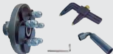
Flangia autocentrante universale per ruote con e senza foro centrale ø foratura min.90 max.210 mm / Universal self-centring flange for wheels with or without central hole, hole ø min. 90 max. 210 mm / Universalspannflansch für Räder mit und ohne Zentralbohrung ø Bohrung min.90 max.210 mm
